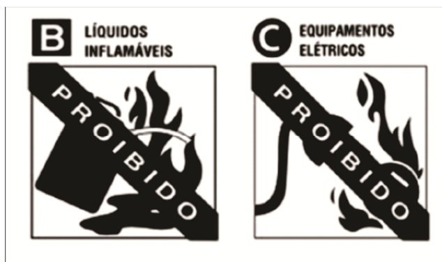
Figura 6: Símbolos de proibição de uso de extintores.
